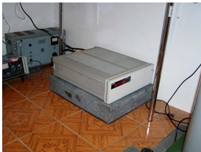
Obr. 10 - Standard času - Cesiové atomové hodiny Symmetricom 5071A
