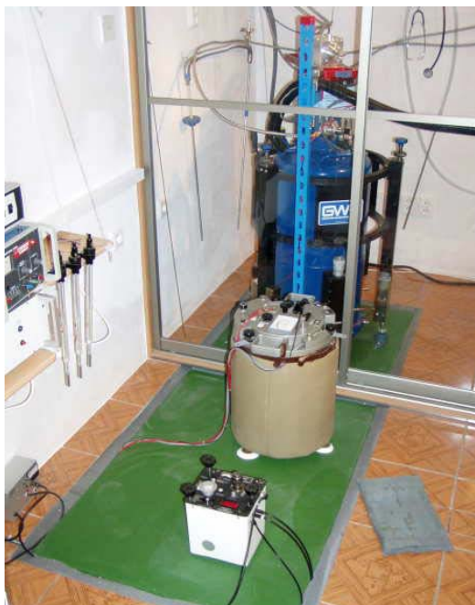
obr. 8 - Gravimetry v gravimetrické laboratoři (vzadu supravodivý gravimetr GWR, uprostřed relativní gravimetr Askania, vpředu relativní gravimetr fy LaCoste-Romberg)
